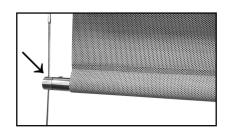
BE SURE CABLE IS INSERTED IN EYELET.
